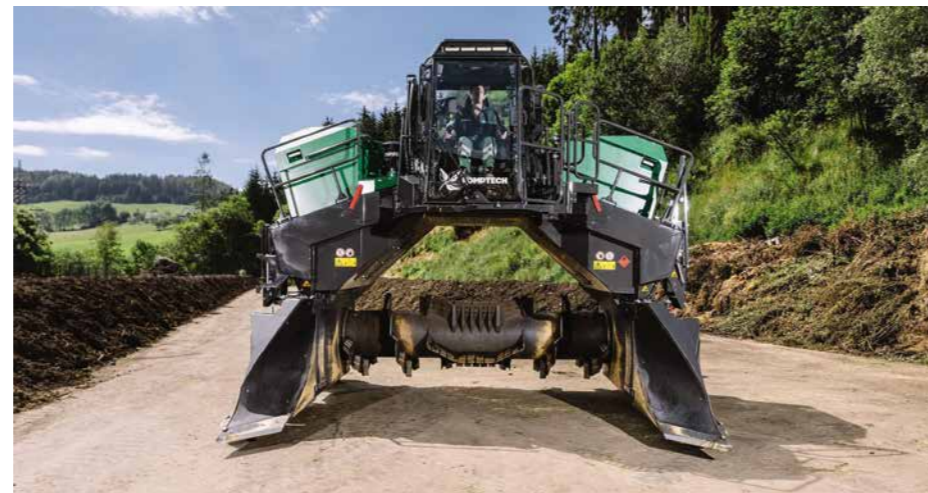
▲ Topturn X4500 Beim Modell Topturn X4500 von der Firma Komptech aus Graz, handelt es sich um einen Kompostumsetzer für Dreiecksmieten. Dieser kombiniert die bewährte Funktionalität mit einer Dimensionierung, die genau auf die Platzverhältnisse kleinerer und mittlerer Kompostanlagen zugeschnitten ist. Ein robuster Rahmen im neuen Design, dazu eine Umsetzwalze mit großem Durchmesser und eine leistungsstarke Hydraulik – so ist hoher Durchsatz, in allen Arbeitssituationen sichergestellt. www.komptech.com
